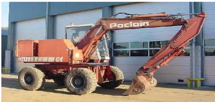
**Fig. VII-1:** Pelle équipée en rétro
