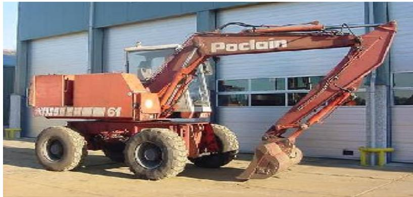
**Figure V.1 :** Pelle équipée en rétro
