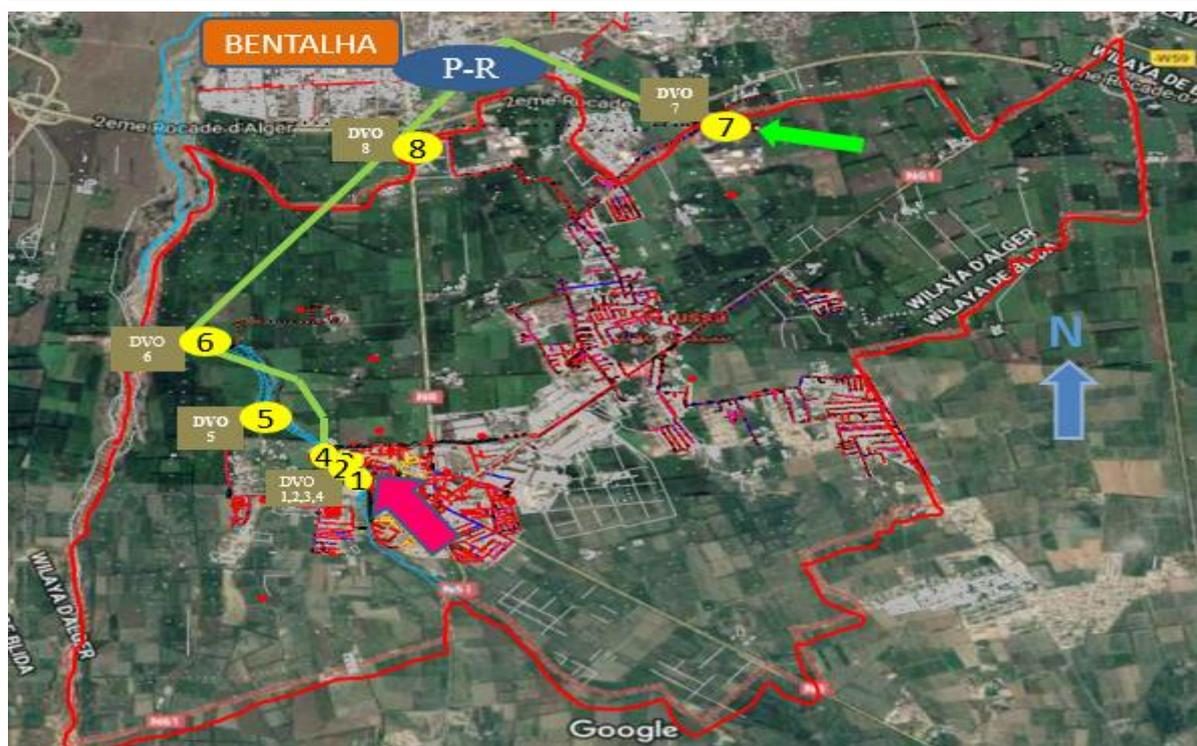
**Figure VI. 4** schéma de la VARIANTE 3 implantée sur image satellitaire
