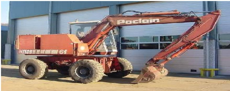
**Figure-4** : Pelle équipée en rétro.
