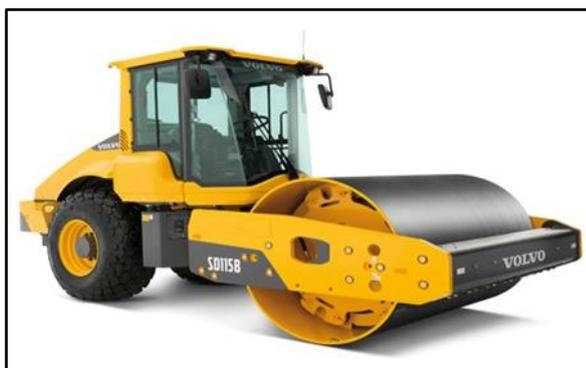
Figure VII-7 : Compacteur à rouleaux lisses
