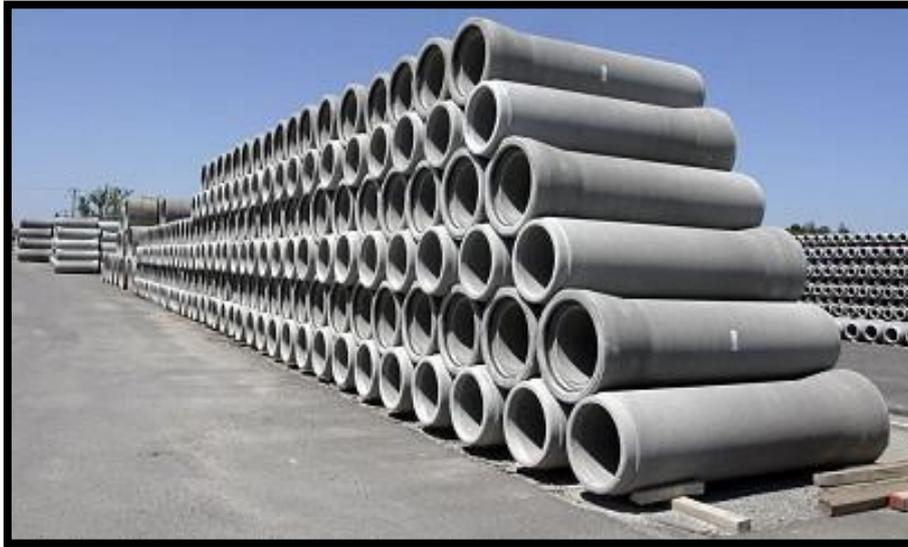
Figure VI.1 : Conduites en béton armé. Source (Google).
