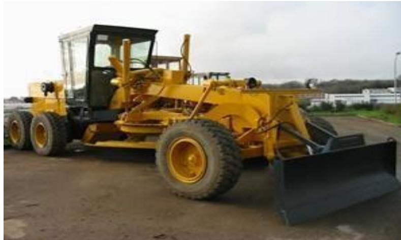
Figure VII.1 : Les engins de décapage (Niveleuse automotrice)
