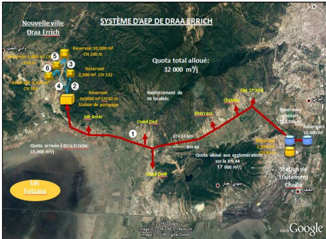
Figure I. 15 : Schéma des adductions de la nouvelle ville Draa Errich (URBAN)
