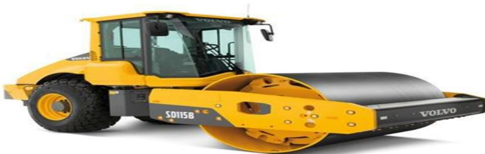
**Figure N°VIII.11** : compacteur à rouleaux lisses.
