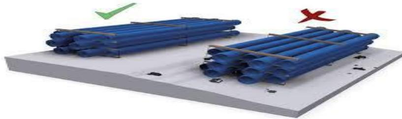
Figure N°VIII.2 : déchargement des canalisations.
