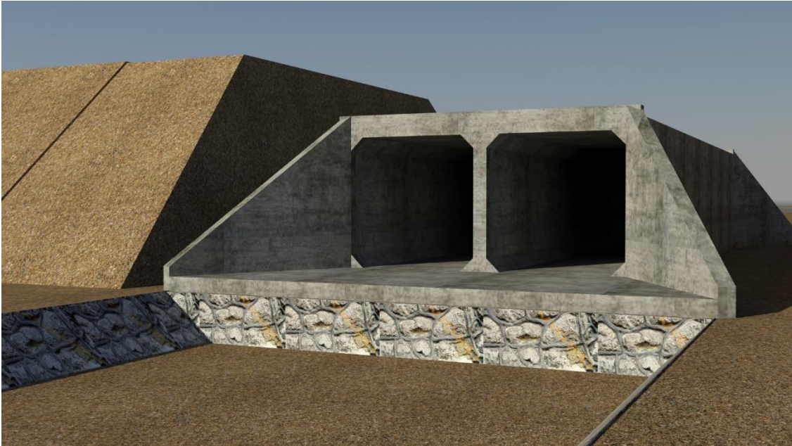
Figure V.22 : schéma de construction d'un dalot
