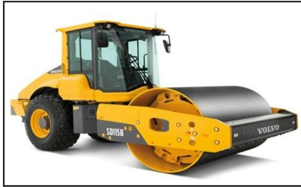
Figure VII-6 : Compacteur à rouleaux lisses
