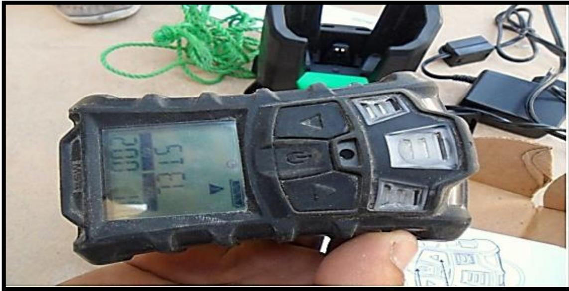
**Figure (IX-4) : Appareil de détection de H<sub>2</sub>S.**
