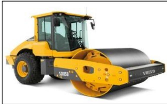
Figure (VIII-8) : Compacteur à rouleaux lisses.
