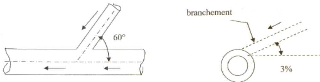
FigureVI-4 : point de raccordement avec inclination (B.Salah(2014), assainissement des eaux usées et pluviales des agglomérations)
