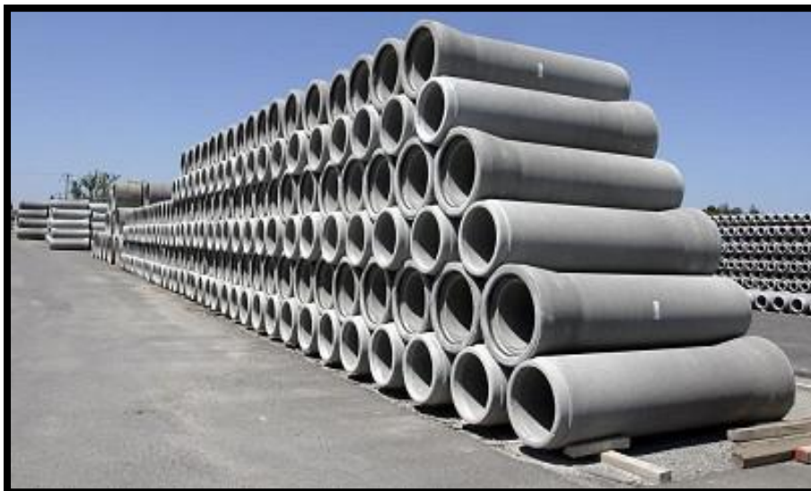
Figure VI.1 : Conduites en béton armé. Source (Google).
