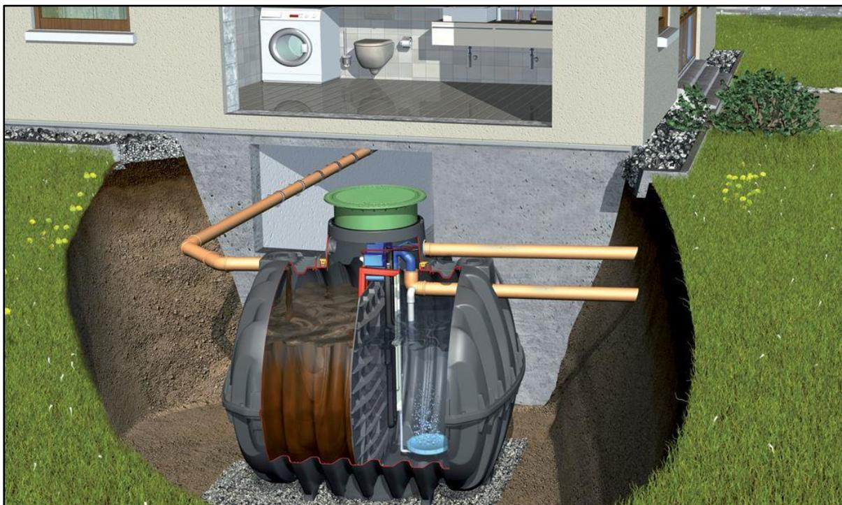
Figure (III-5) : schéma représentatif d'un micro stations d'épuration
