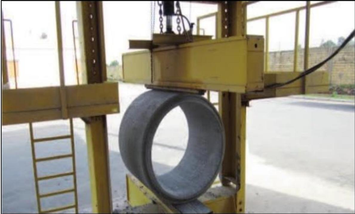
Figure (VI-4) : L'essai à l'écrasement sur les conduites en béton
