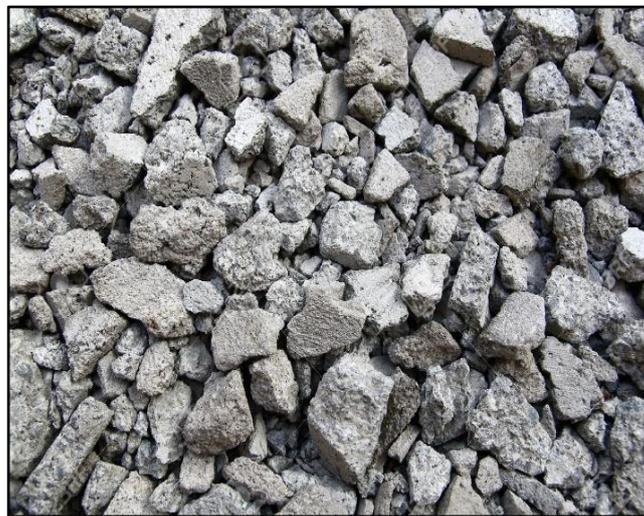
Figure (VI-24) : Béton concassé
