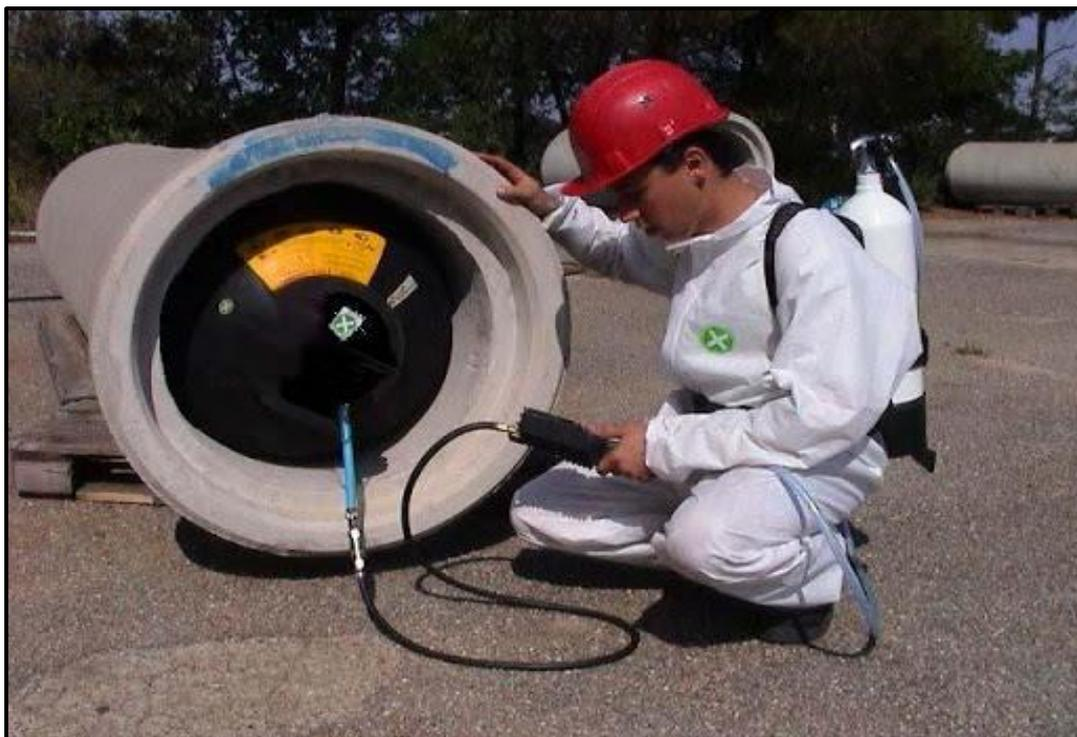
Figure (VI-5) : L'essai d'étanchéité à l'air sous pression
