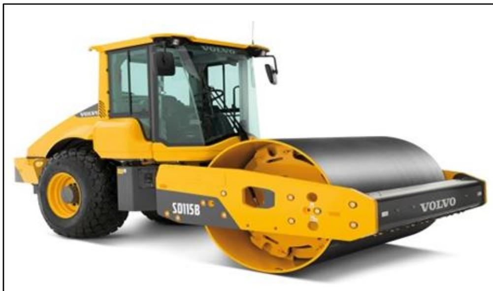
Figure (VII-14) : Compacteur à rouleaux lisses
