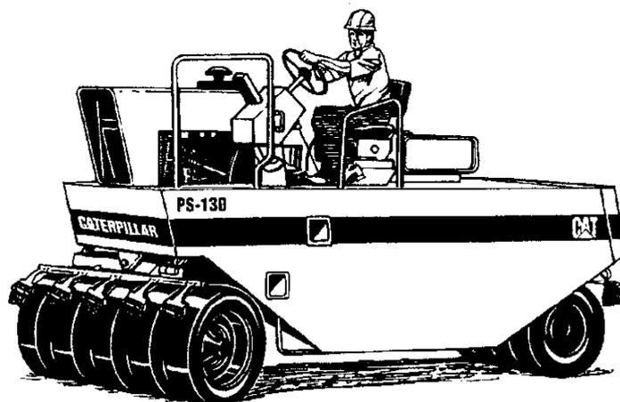
Figure VII.2 Compacteur à pneus
