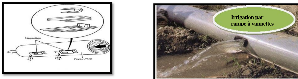
Figure II.2 : Irrigation par rampe à vannettes.
