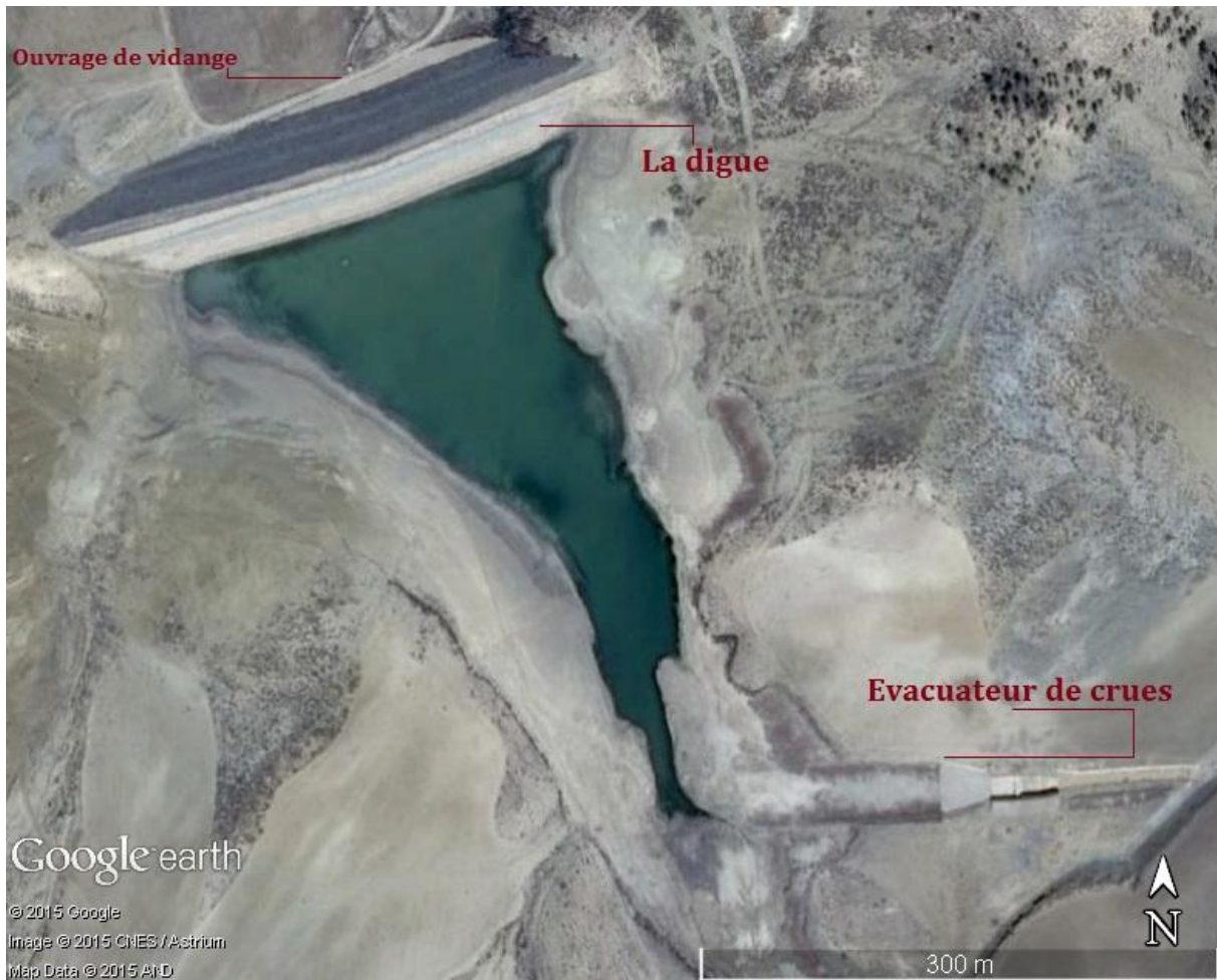
Figure III.2 : Photo satellitaire montre les ouvrages de base de la retenue collinaire GOURIGUEUR (source : Google earth, 2015)
