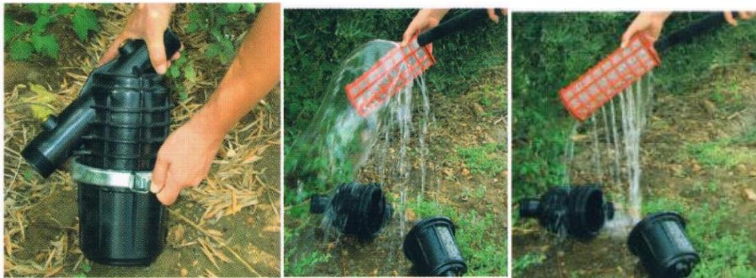
Figure 15 : Nettoyage filtre à tamis
