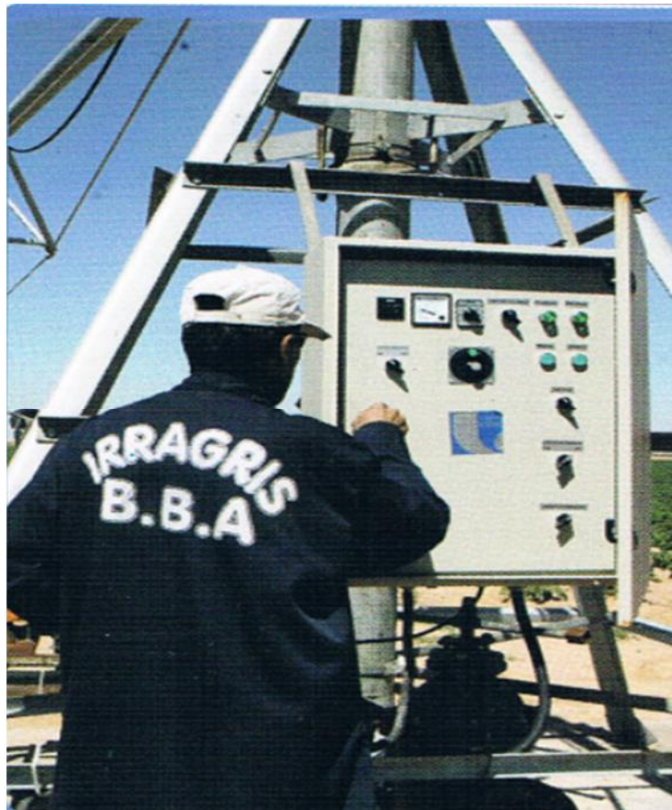
FIGURE V.13) représente la centrale de commande
