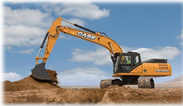
**Figure VII-3: Pelle équipée en rétro**
