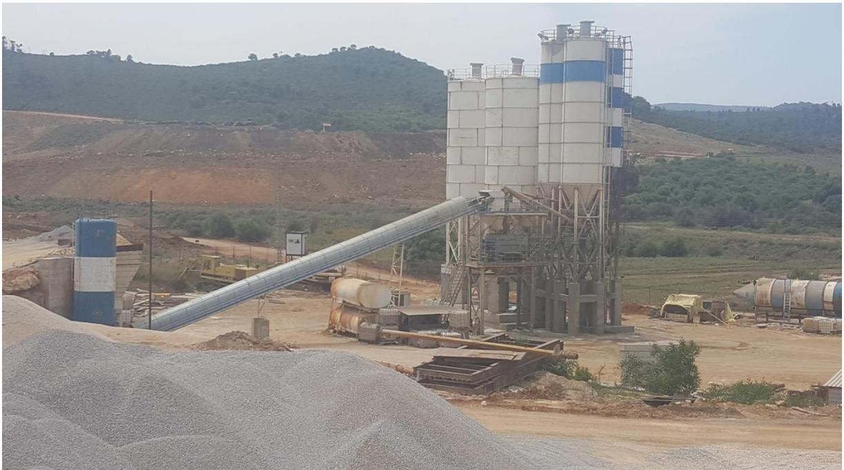
**Figure 14 :** Centrale à béton fixe
