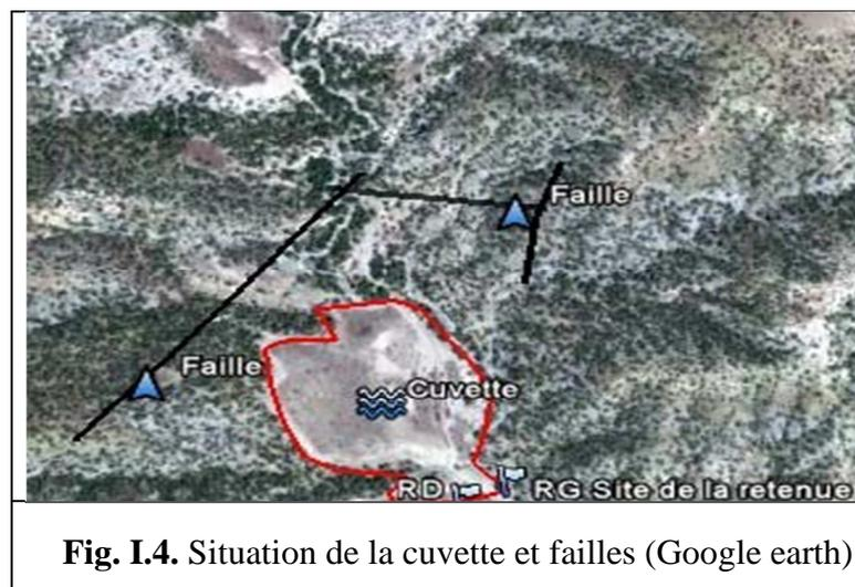
Fig. I.4. Situation de la cuvette et failles (Google earth)
