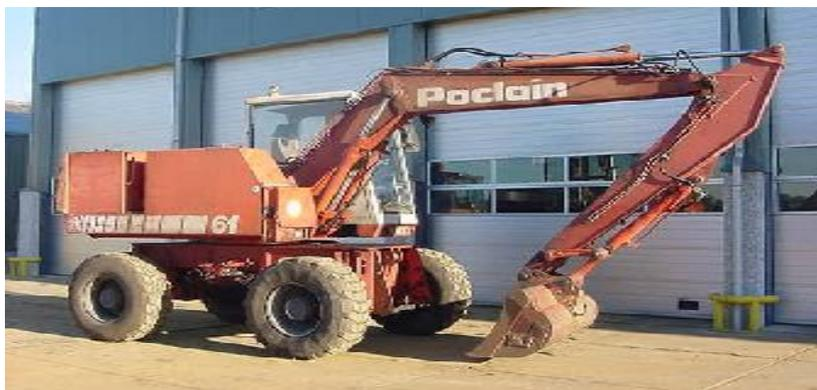
**Figure VIII-2 : Pelle équipée en rétro**
