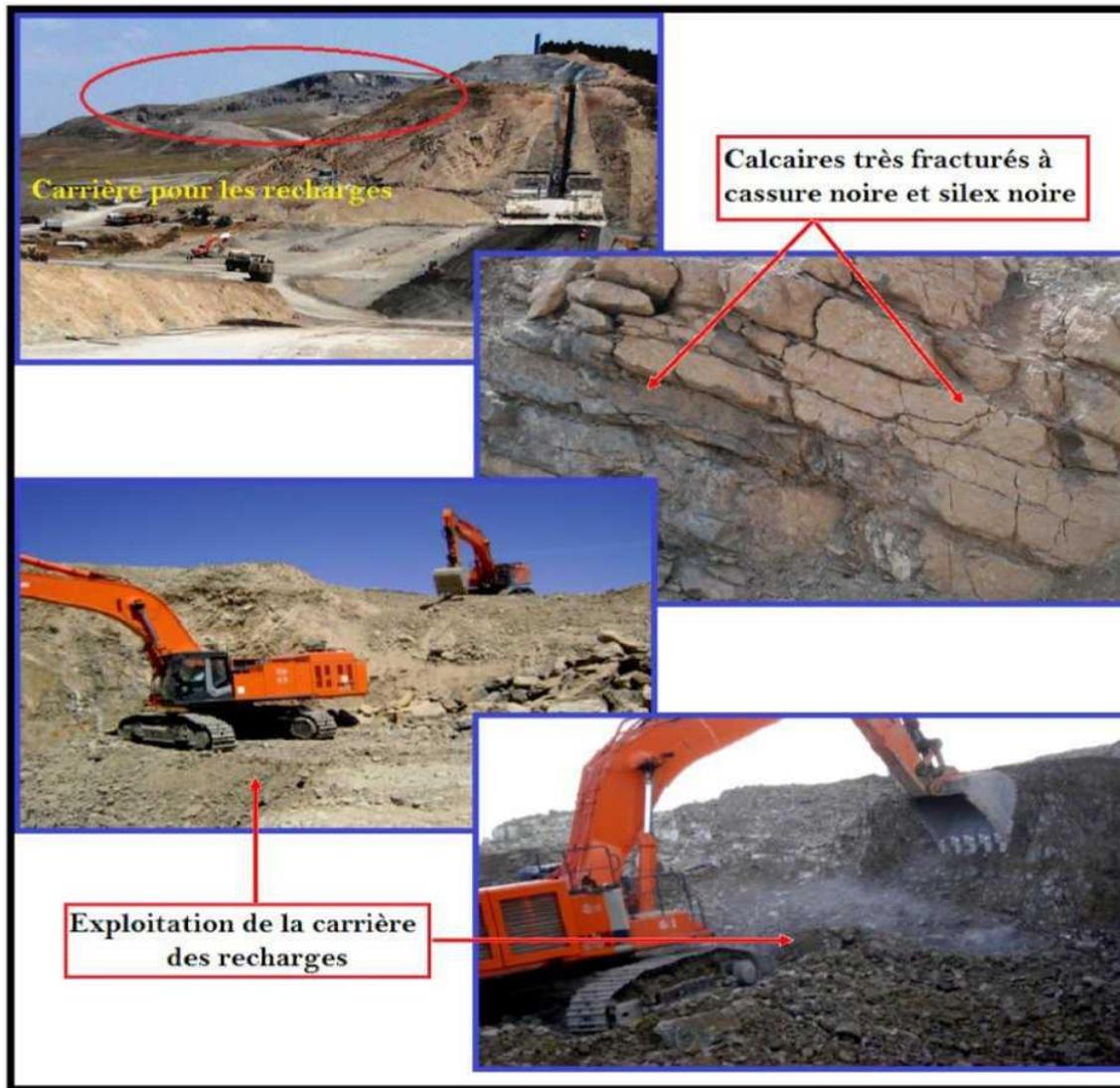
**Figure II.5** La zone d'emprunt des calcaires pour les recharges
