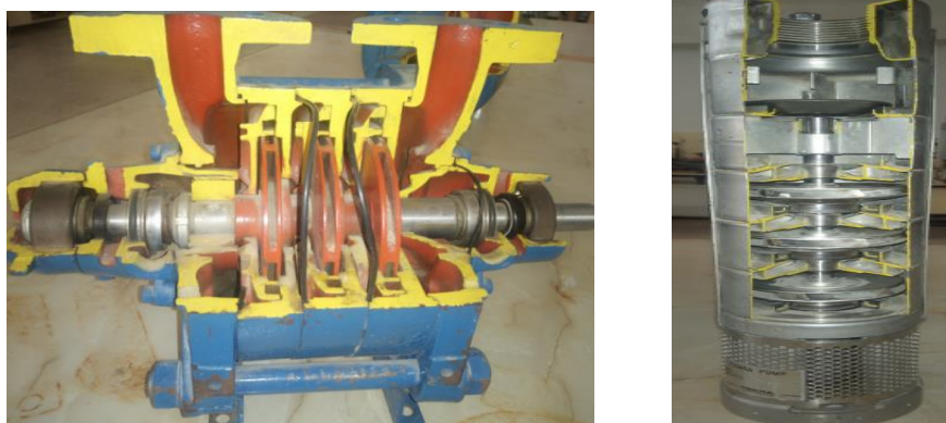
Fig.2.2. Pompes horizontale et verticale multicellulaire
