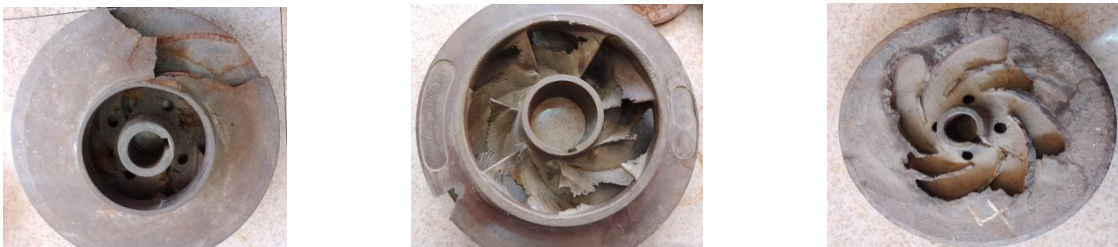
Fig. 7.1 Corrosion et érosion de roues de pompes centrifuges par cavitation
