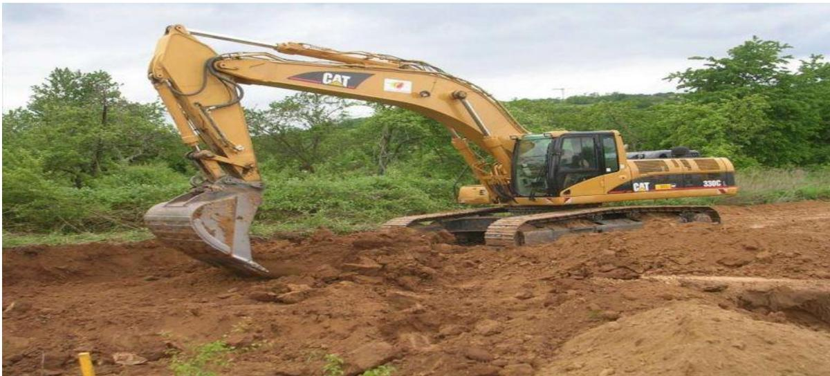
*Figure VI.01: Pelle à chenilles avec godet à position rétro.*
