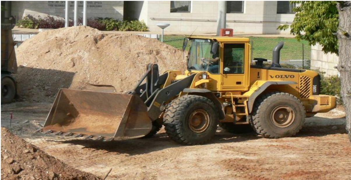
*Figure VI.03: chargeur pneumatique*
