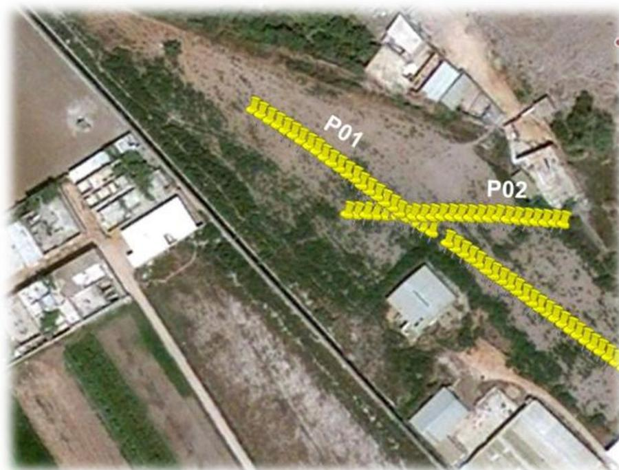
**Figure I.11** : Implantation des profils de résistivités électriques.
