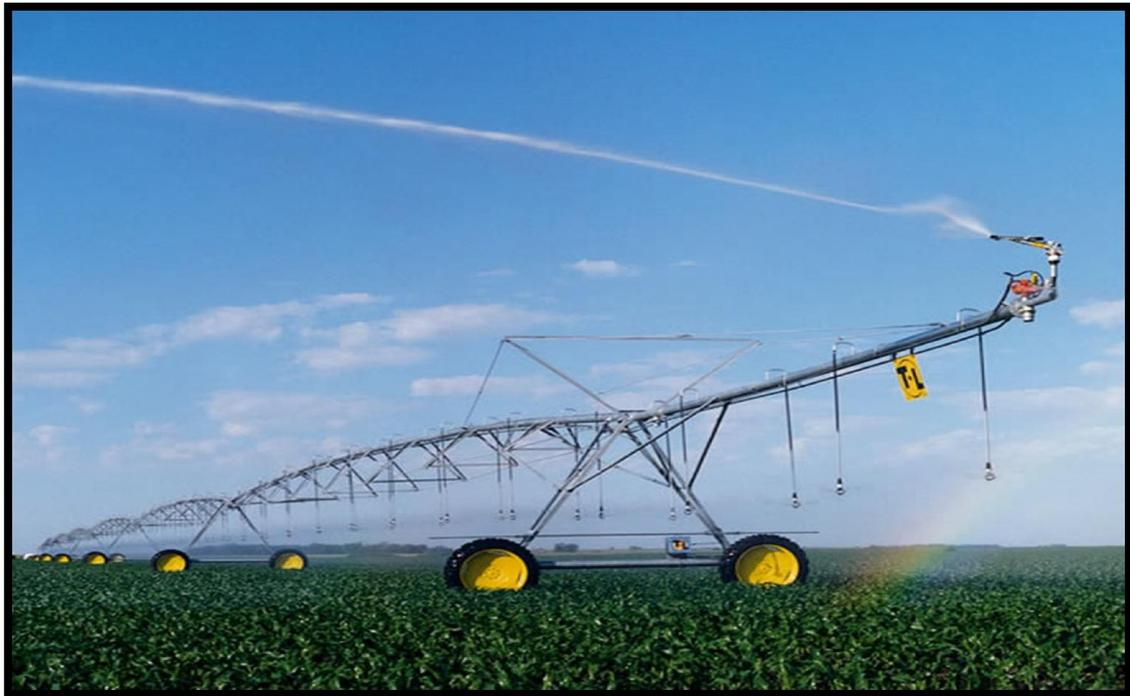
**Figure. V.3 :** l'irrigation par pivot
