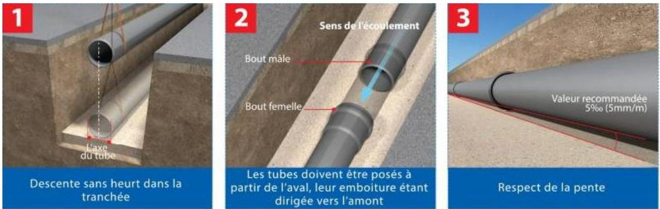
Figure VII-2 : pose de canalisation (Source : Groupe Chiali)
