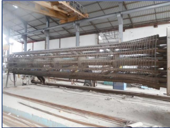
Figure VI-4 : fabrication d'un tuyau en béton armé avec centrifugation (Source : Usine TRANS CANAL Centre S.P.A)
