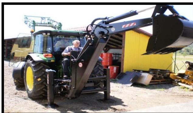
**Figure VII.6:** Pelle rétro hydraulique pour tracteur
