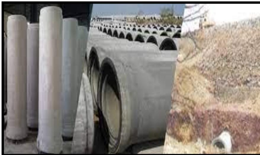
**Figure VI.3:** conduites en béton armé.
