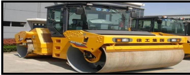
Figure VII.9: Compacteur à rouleaux lisses.
