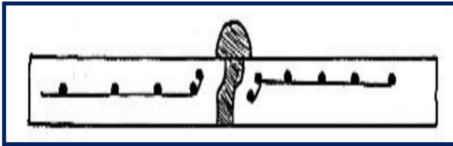
Figure VII-5: Joint à demi-emboitement.
