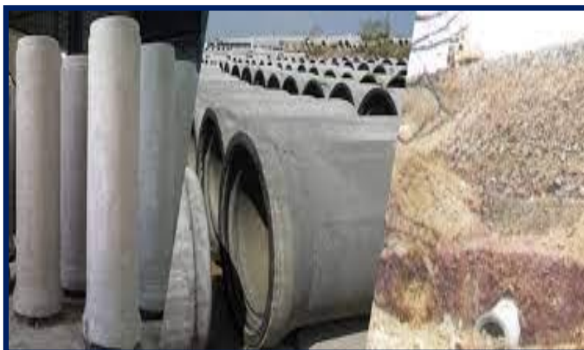
Figure VII-2: conduites en béton armé.
