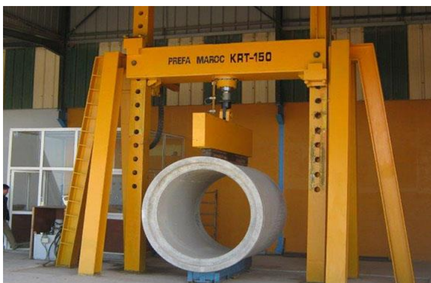
Figure VI-4: L'essai à l'écrasement sur les conduites en béton
