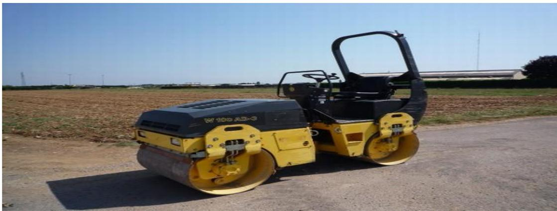
**Figure VII.4** Compacteur à rouleaux lisses
