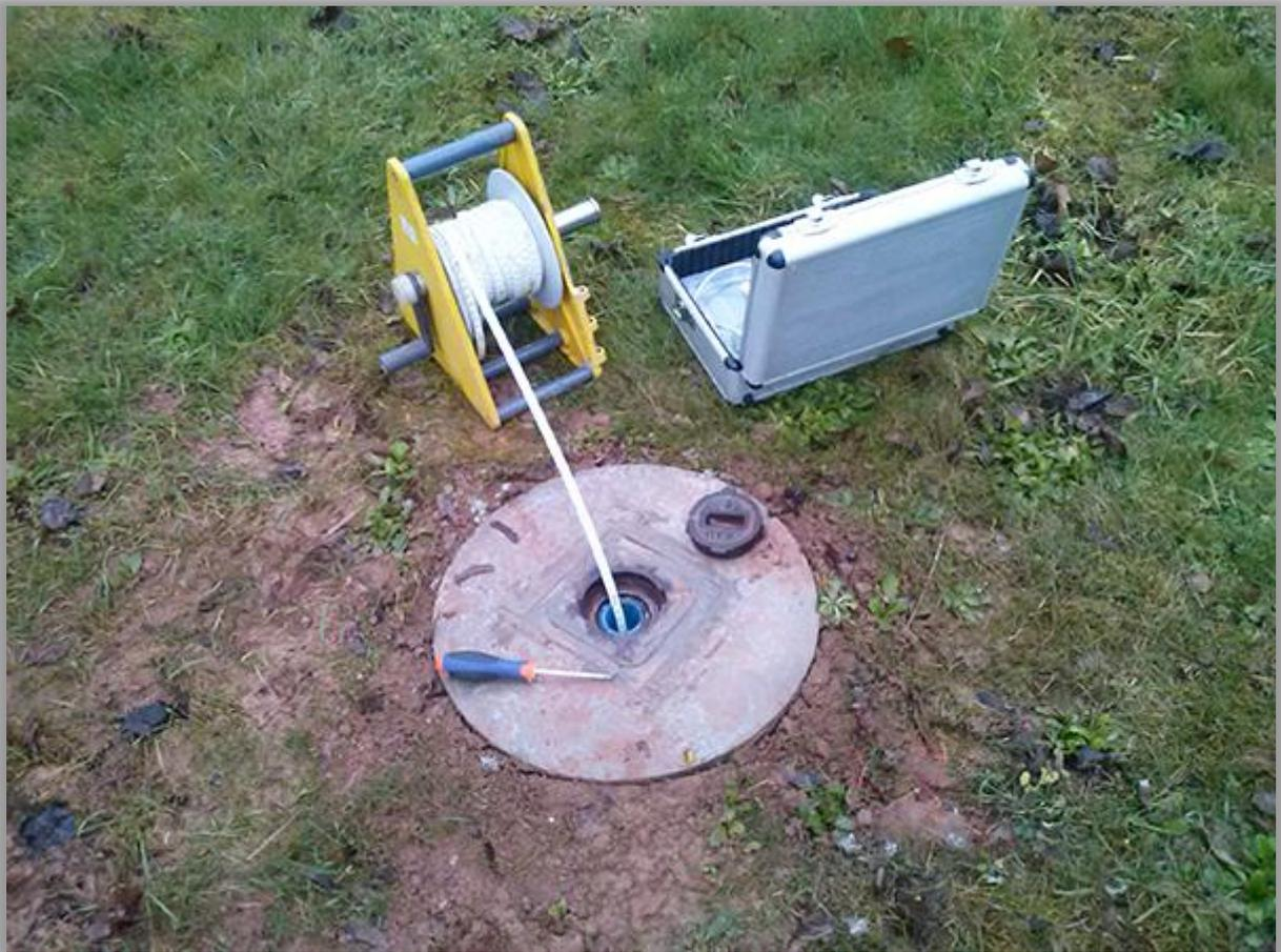
**Figure VIII.4** : Piézomètre en exploitation, (Kornog Géotechnique, 2011)
