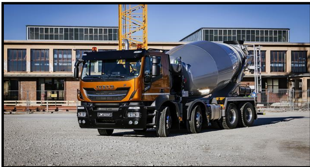
Figure VI-8: camion à bétonnière.
