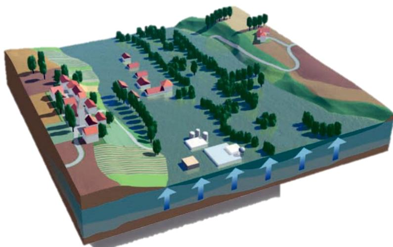
Figure 1: Inondation par remontée de nappe
