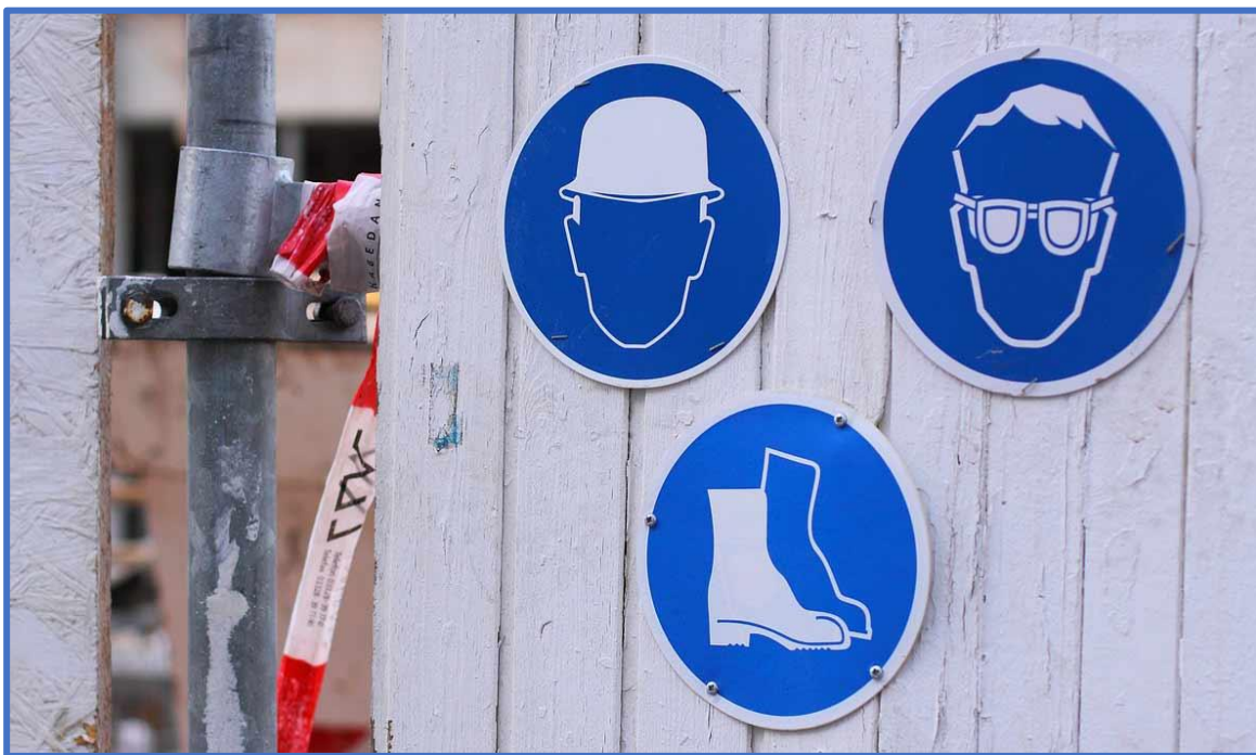
Figure VII. 2 : Pictogrammes d'obligation du port des EPI dans un chantier
