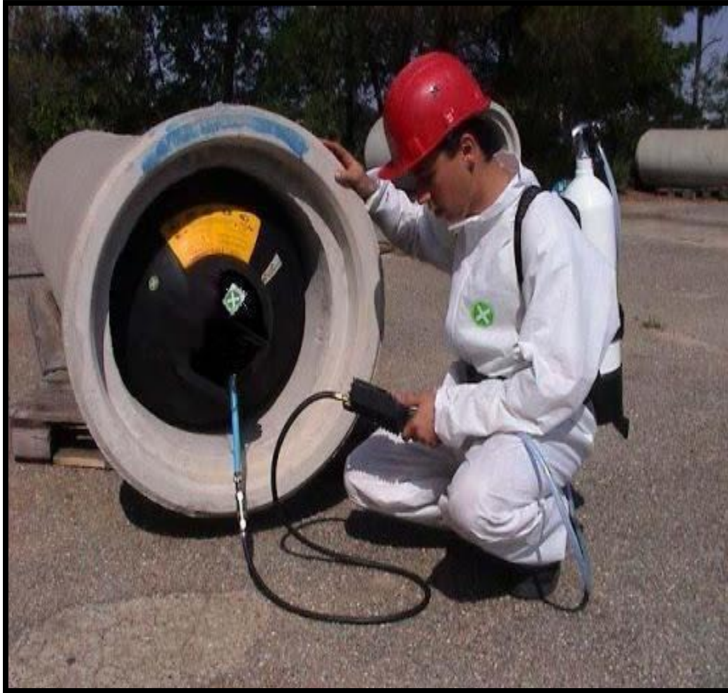
Figure VI-5 : L'essai d'étanchéité à l'air sous pression
