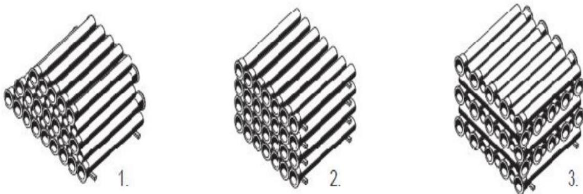
**Figure VIII.1** : Méthodes de stockage des tuyaux (Bendida 2020)
