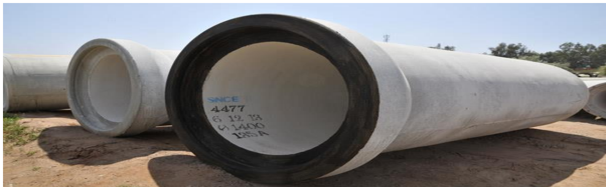
Figure VII-1: canalisations en CAO.
