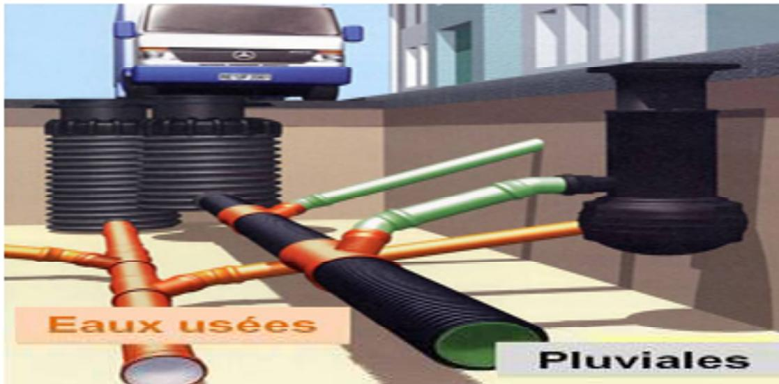
Figure III 3:schéma représentatif des branchements dans le système séparatif
