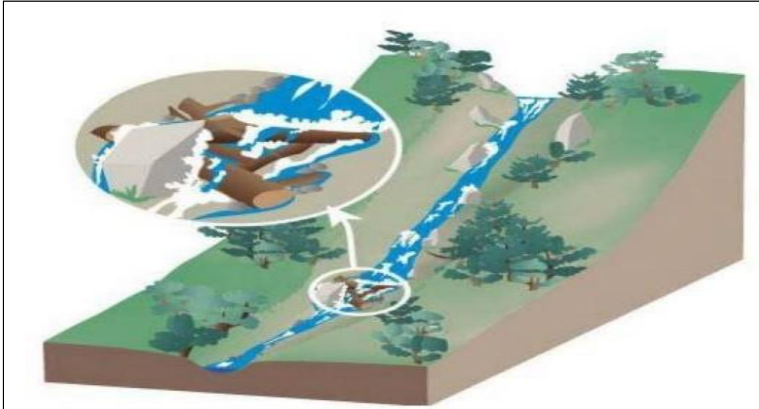
Figure I-2 : Embâcle sur un torrent, inondation par crue torrentielle
