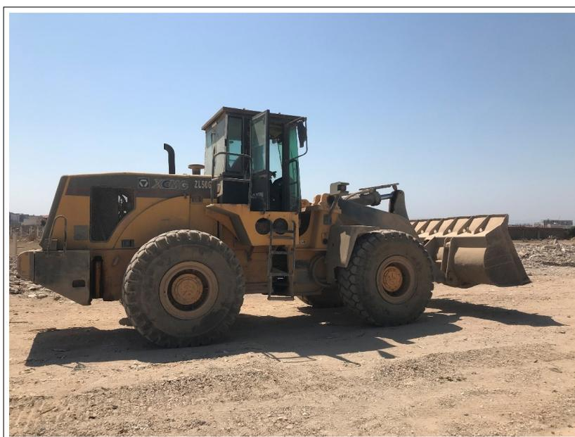
**FIGURE E.3** – Chargeuse sur pneus (XCMG)
