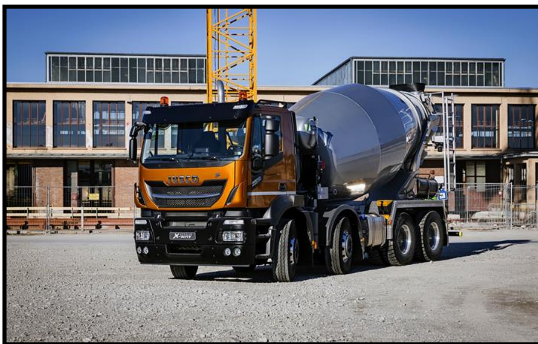
Figure VI. 8 : camion à bétonnière.
