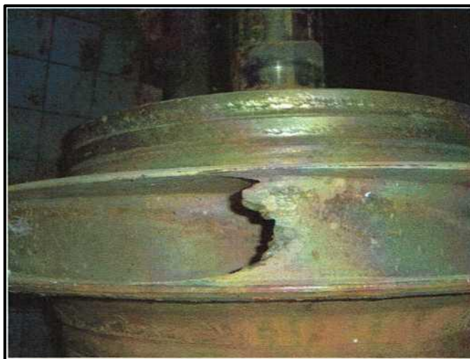
Figure 18 : SP Khemis II - Exemple de dégât sur une roue de pompe suite à un Fonctionnement en cavitation
