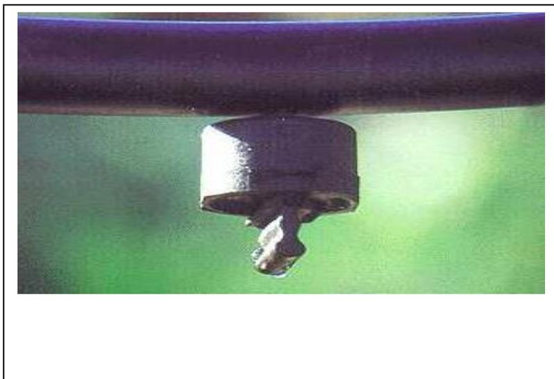
**Figure VI- 9:** Exemple d'un Goutteur
