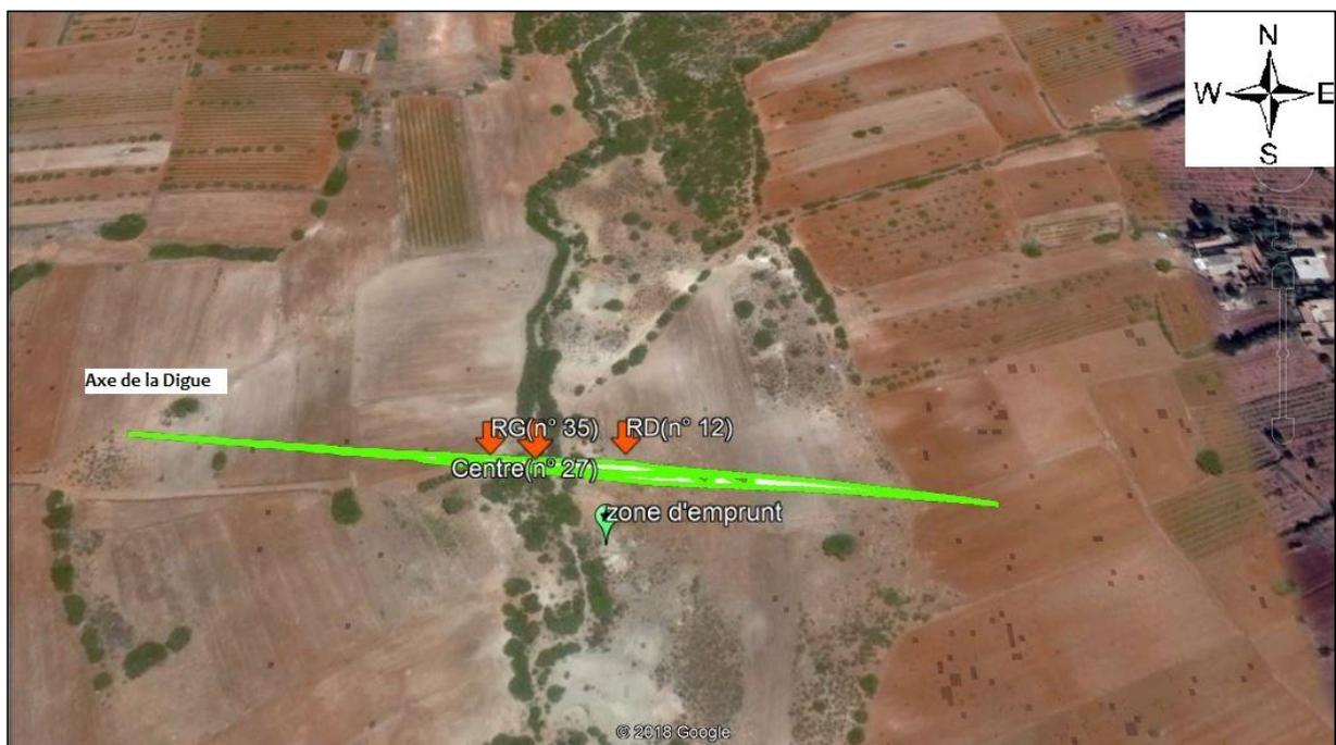
Figure II.9 Image satellitaire présenté les Forages recommandés pour le site Echelle 1/4000
