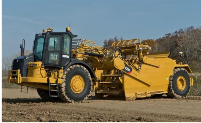
**Figure VII.5 : Décapeuse automotrice**
