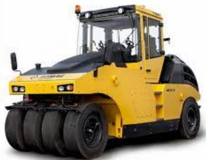
**Figure VII.2** Compacteur à pneus
