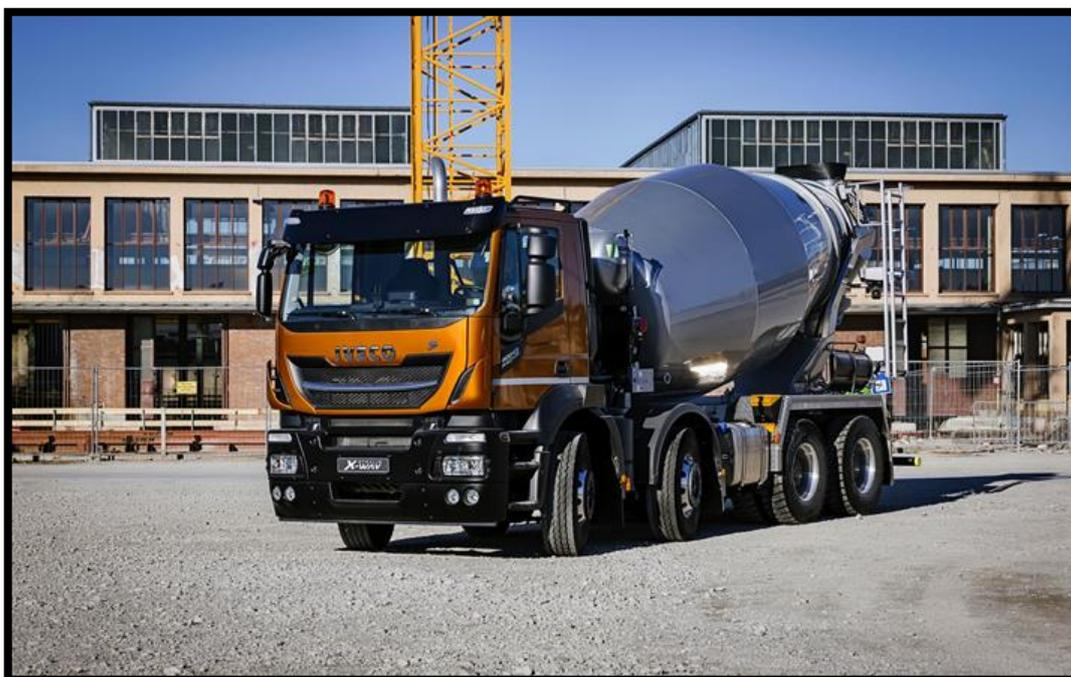
**Figure VII.8 : camion à bétonnière.**
