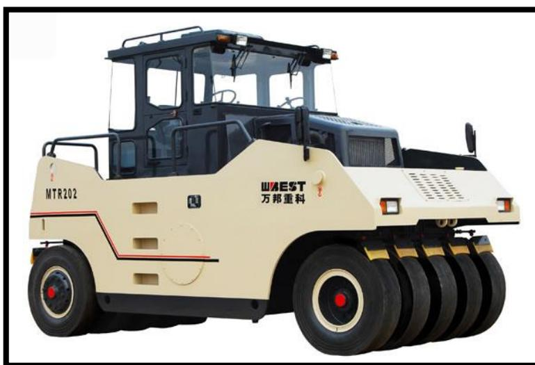
**Figure VII.1** : Compacteur à pneus.
