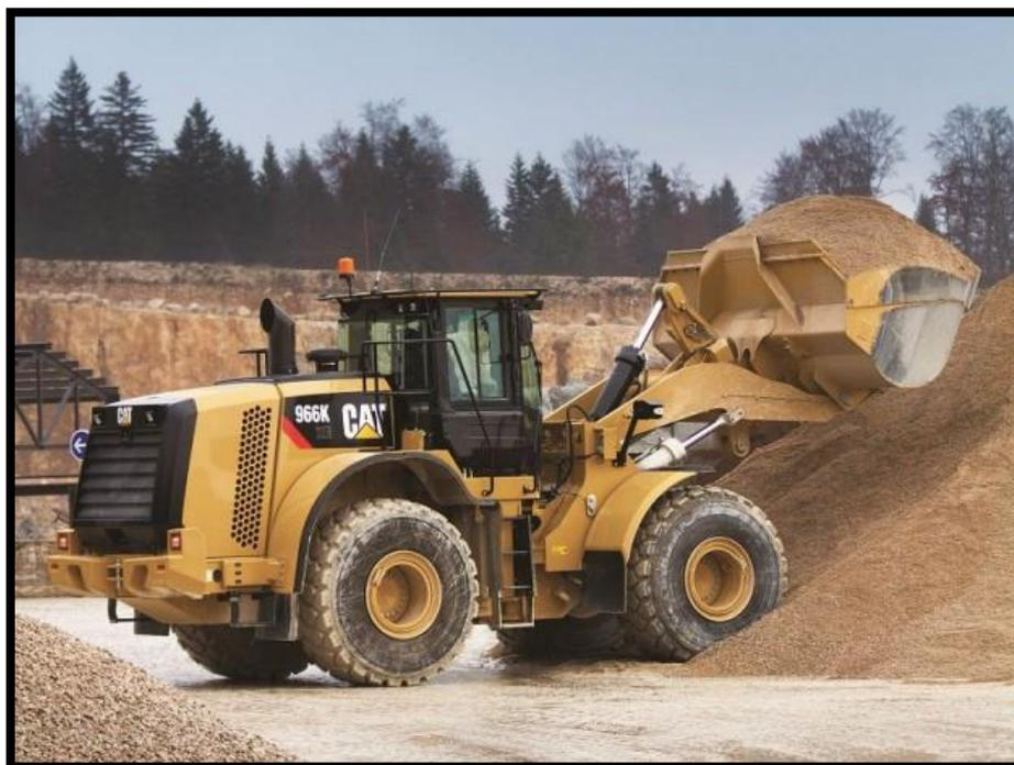
**Figure VII.6 : chargeur pneumatique.**
