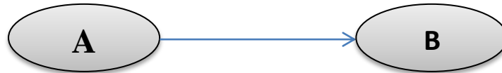
Figure n°VI.2 L'opération B ne peut commencer que si l'opération A est complètement achevée.
