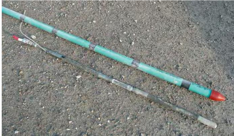
Figure IV.02 : Tube à manchette/obturateur double (photo Solétanche-Bachy-2014).
