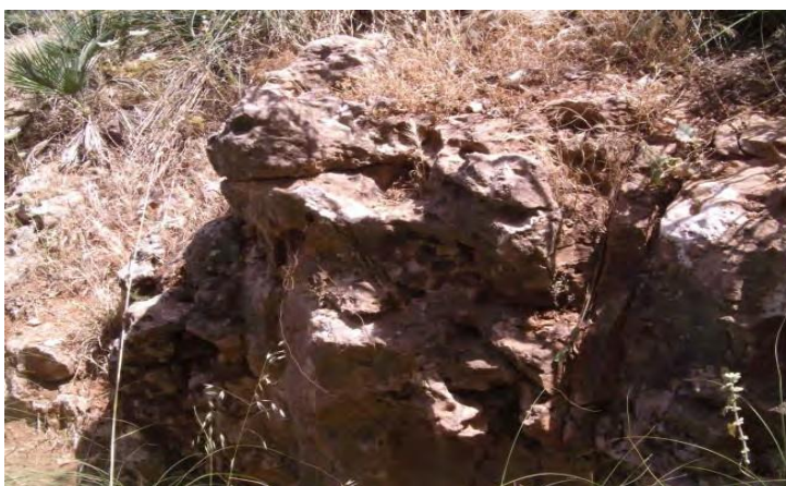
Figure II.7 : Détails de l'affleurement en rive droite, on observe la karstification des matériaux.
